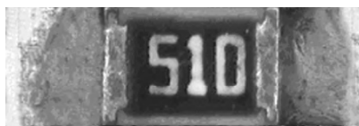
图 8 焊料不足元件及焊点图像
